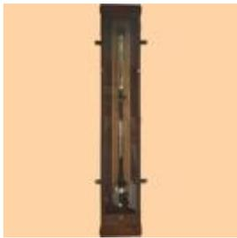
Instrumento usado para medir la presión atmosférica a partir de las variaciones que experimenta el nivel del mercurio en una columna de 1 m de altura asociadas a los cambios de presión, para alcanzar el estado de equilibrio.
