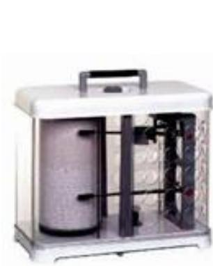
Instrumento que permite tener un registro continuo de la humedad relativa y de la temperatura ambiente de manera simultánea. Cabe destacar que el higrógrafo es de cabellos, preferiblemente de mujer rubia y el termómetro es de láminas bimetálicas.
