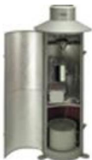
Es un pluviómetro registrador; lleva asociada una plumilla, que continuamente está registrando la precipitación. Permite determinar las horas de inicio y fin de la precipitación, las cantidades y en su caso, la intensidad de la precipitación.
