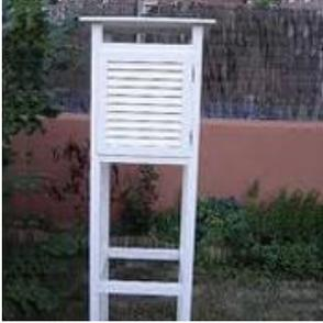
Es una caseta de madera pintada de color blanco, con paredes construidas por persianas simples inclinadas que permiten una adecuada ventilación, así como por una chimenea que permite la circulación del aire en su interior.
