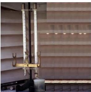
Instrumento utilizado para medir la humedad relativa. Consta de dos termómetros de mercurio, uno de ellos con el depósito de mercurio siempre mojado, por el aporte contiguo de agua a través de una gasa impregnada de agua. Debido a este aporte continuo de humedad, habrá una diferencia de temperaturas registradas (el termómetro húmedo siempre estará más frío). De la diferencia de estas dos temperaturas se obtiene la humedad relativa del ambiente.
