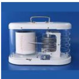
Instrumento usado para medir la presión atmosférica en este caso, basado en las expansiones o contracciones que sufre una cápsula aneroide asociados a los cambios de presión. Estos cambios se registran con una plumilla.
