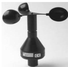
Instrumento para determinar la velocidad del viento.
